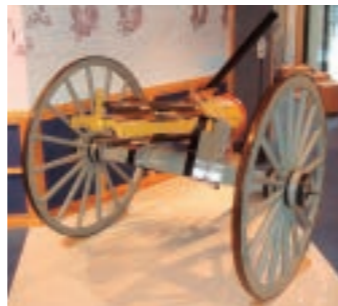
▲復元されたガトリング砲（河井継之助記念館所蔵） 当時最新鋭の機関銃であったガトリング砲を河井継之助は2門購入し備えたが、軍事教育を施す時間がなく、十分に使いこなすことができなかった。
