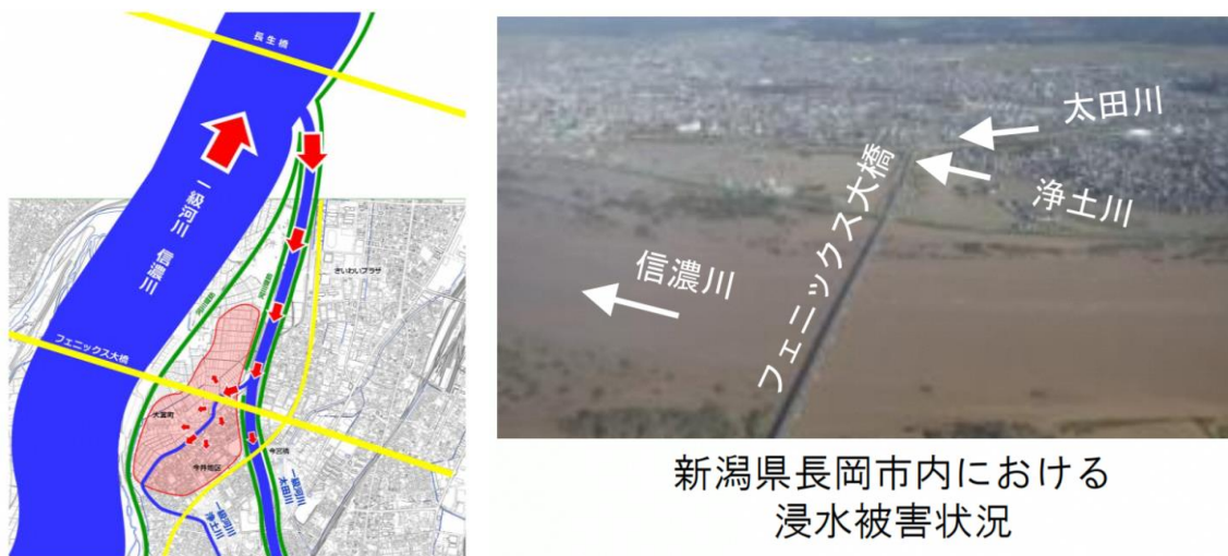
図2-3-5-4 <<令和元年台風第19号被害状況(バックウォーターによる浸水被害の様子)>> (出典:長岡市危機管理防災本部資料、信濃川水系緊急治水対策プロジェクト資料・国土交通省(写真))
