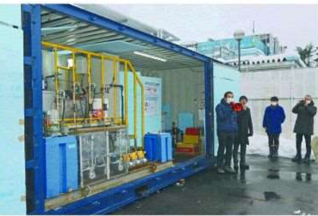
バイオ産業の実証事業で使用される膜分離リアクター。長岡市寿3
