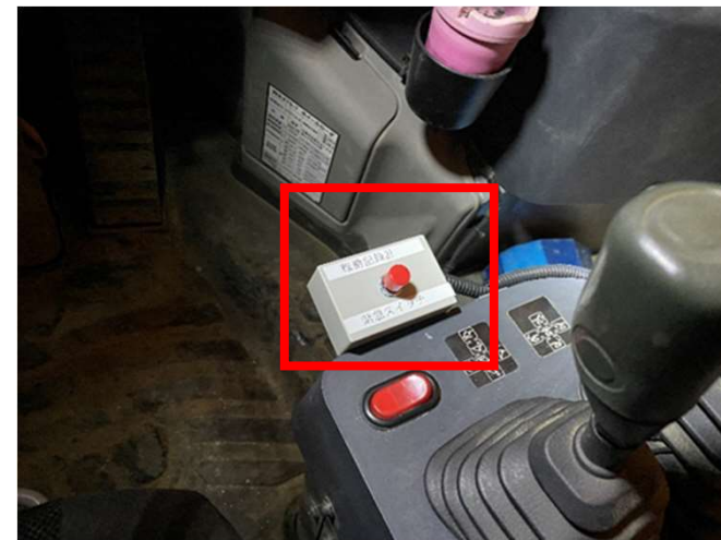
④緊急スイッチ 緊急時に車両から事務所へ映像を飛ばす
