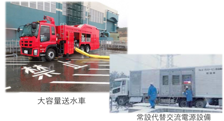
【重大事故対策のための設備】
