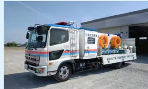
台風や集中豪雨により宅地や道路が冠水した際、被害を最小限に抑えるためにあふれた水をくみ上げて川に排水する車両です。
