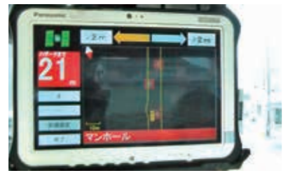
▲経験の浅い運転員の作業を支援する音声ガイダンス装置
