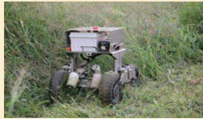
▲補助金を活用して開発された除草ロボット。操作が簡単でパワフルに動き、高さのある草にも対応します
