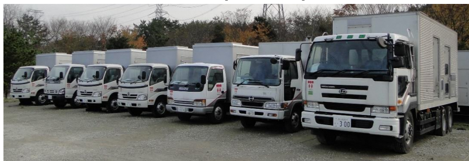
原子炉を冷やすためのポンプ等へ電気を供給する車両
