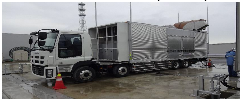
大容量の電気を供給する車両
